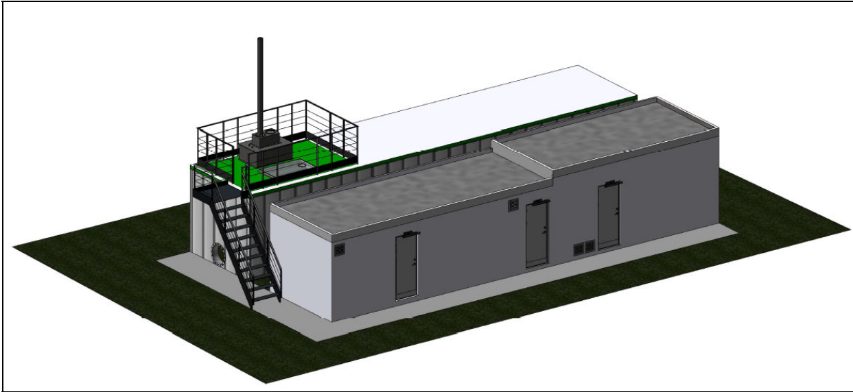
Bild 4: Graphische Darstellung der einstufigen modularen Kompaktfaulung
